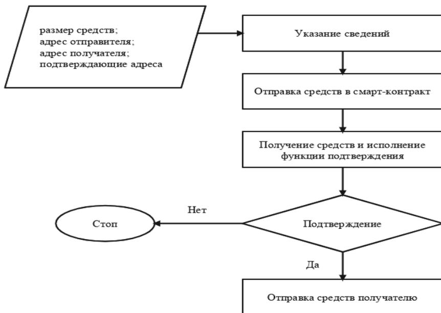
Рисунок 5. Блок-схема перевода средств
