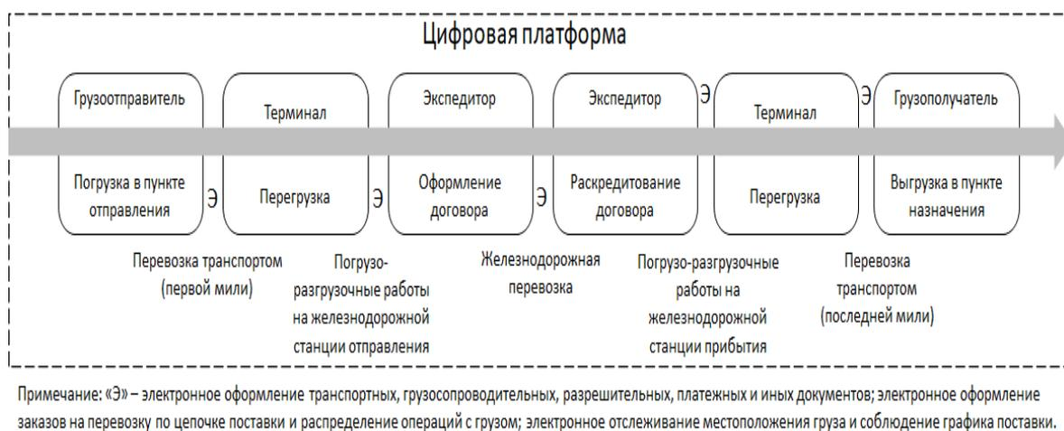
Рисунок 2.5. Типовая цепочка смешанной перевозки, заказ и выполнение которой предусмотрены цифровым платформенным решением
